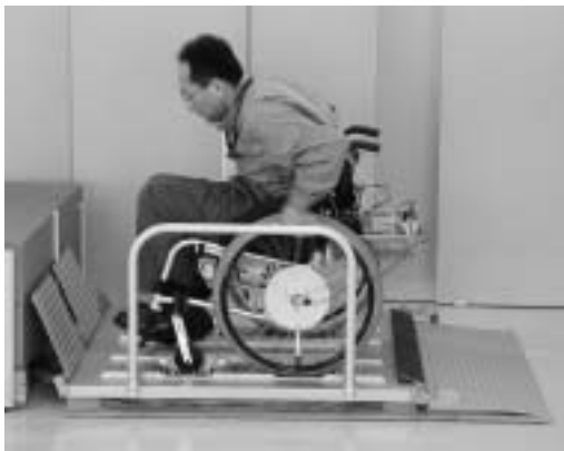
研究開発型企業重点技術指導例 車いすの動力を利用した「無動力段差解消機」の開発
