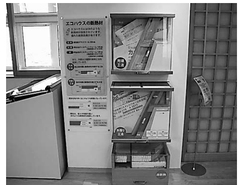
エコハウス2階の断熱施工事例
