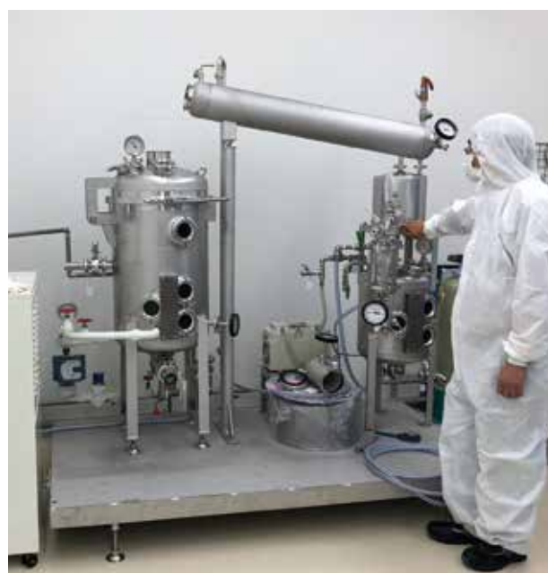
導入した蒸留装置
