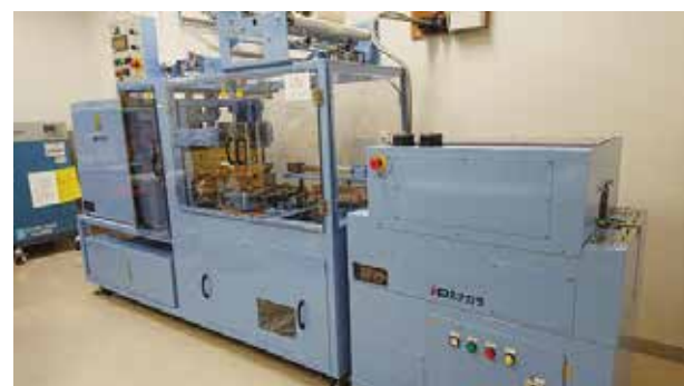
「写真1」 静電シール包装装置（シュリンク包装機）
