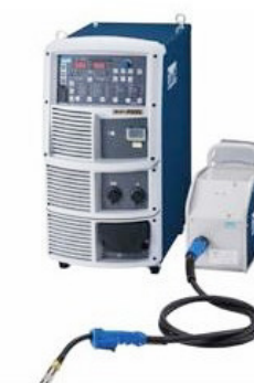
導入したデジタルインバータ溶接機
