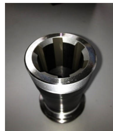
試作品（内径側溝加工）
